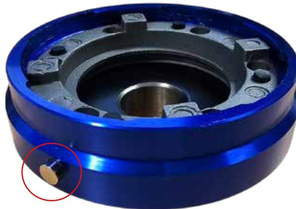
Bei dieser Ausführung ist das Lenkrad über einen Schnellverschluss mit der Lenksäule verbunden. Durch Betätigen des seitlichen Knopfes und einer anschließenden leichten Drehbewegung wird das Lenkrad entriegelt und kann entnommen werden. Der Einbau des Lenkrades geschieht in umgekehrter Weise. Nach dem Einsetzen erfolgt eine kleine Drehbewegung bis der Knopf wieder eingerastet ist.
