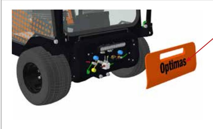
Die Frontabdeckung kann an den vorgesehenen Auskerbungen abgezogen werden, die sich an der unteren Kante befinden. Hinter der Frontabdeckung befindet sich der Hydraulik- und Wasseranschluss.
