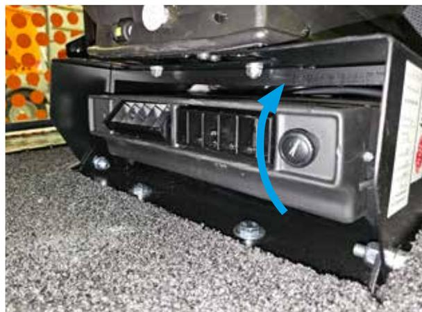
Bild 3 – Rechtsdrehung: Kühlere Einstellung
